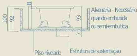
Exemplo de instalação sobre o piso, na praia.
